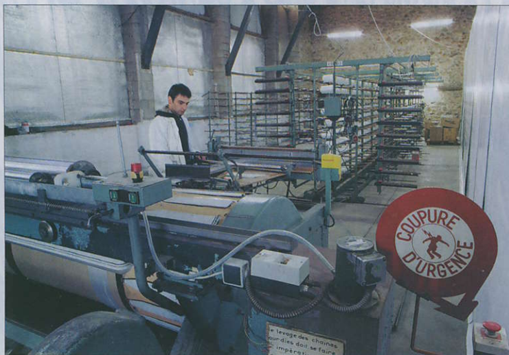
L'ourdissoir, une machine imposante qui prépare les fils polyester pour le tissage de l'Utex; en effet ces fils...
