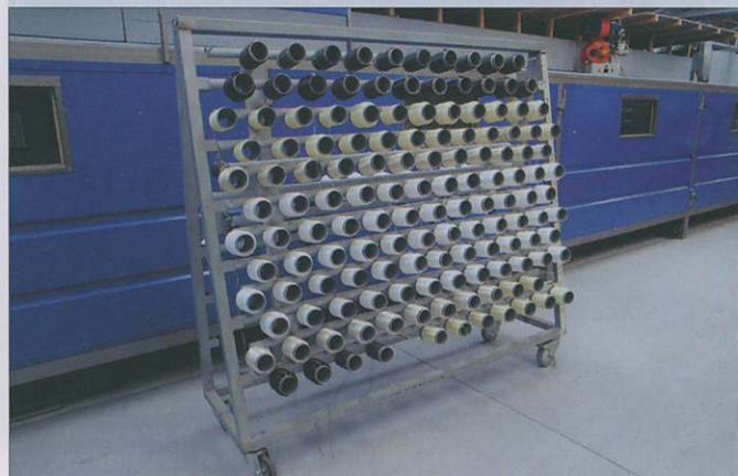
... arrivent chez CLM sous forme de petites bobines. A la sortie de l'ourdissoir, la bobine fait 3,40 m de large.
