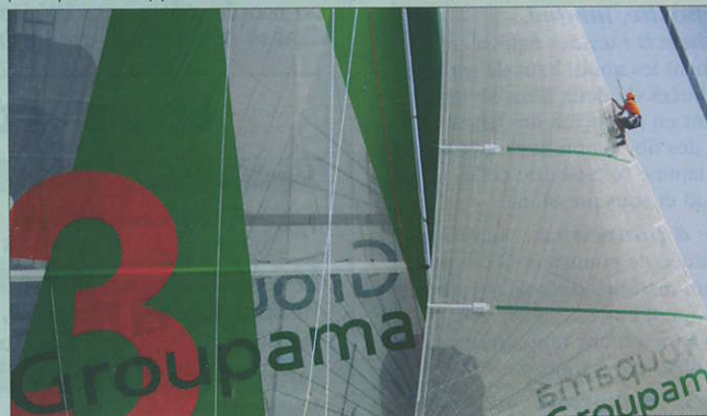
Les voiles en Cuben Fiber du maxi-tri Groupama 3; seul défaut de ce matériau : il manque de stabilité de formes.
