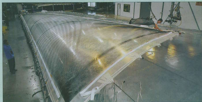
Dépose des fibres sur un géniois 3DL de Challenge Twelve.
