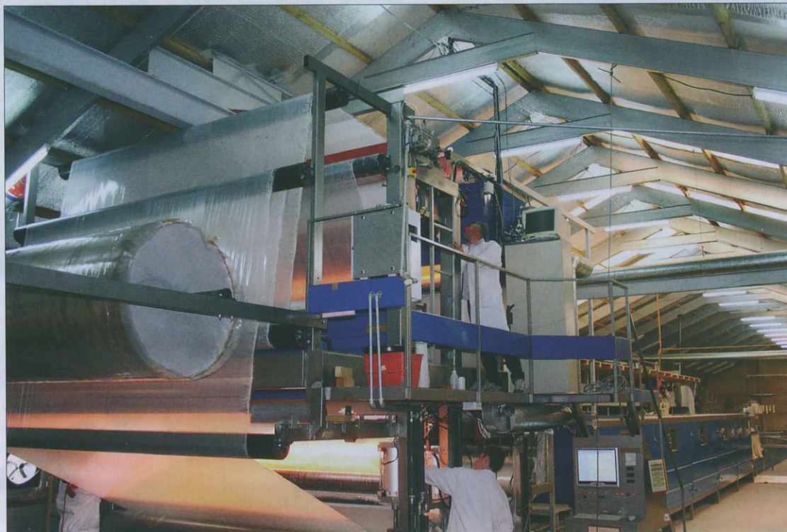
L'énorme machine à laminer réalise toutes les opérations pour appliquer l'Utex sur le film Mylar, positionner les fils, encoller, chauffer...
