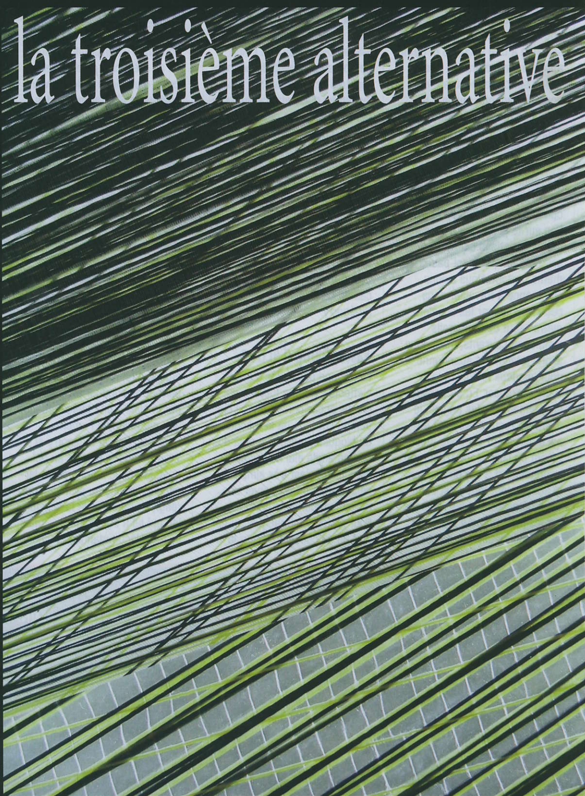
Trilam en haut, D4 en bas : la différence d'aspect est due à la "peau extérieure", en Mylar pour le D4, en Utex pour le Trilam.
