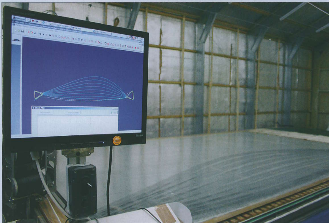
Le logiciel gère le bras qui positionne les fibres sur le complexe Utex-Mylar.
