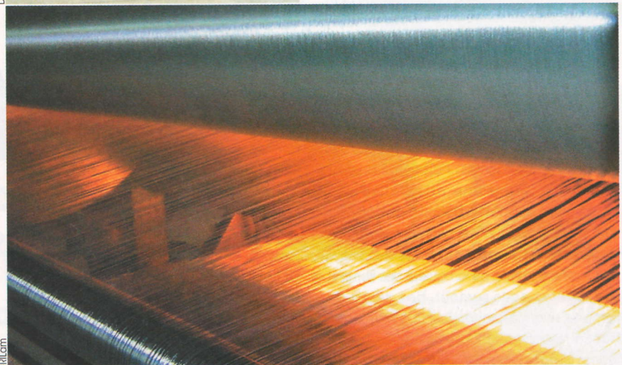
La machine soutenue par un portique dépose des bandes 3 Di sur un moule.
